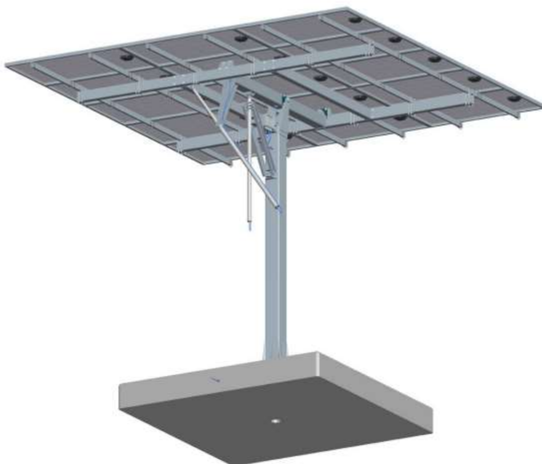
Figura 4.28 Panelet solare të montuara
