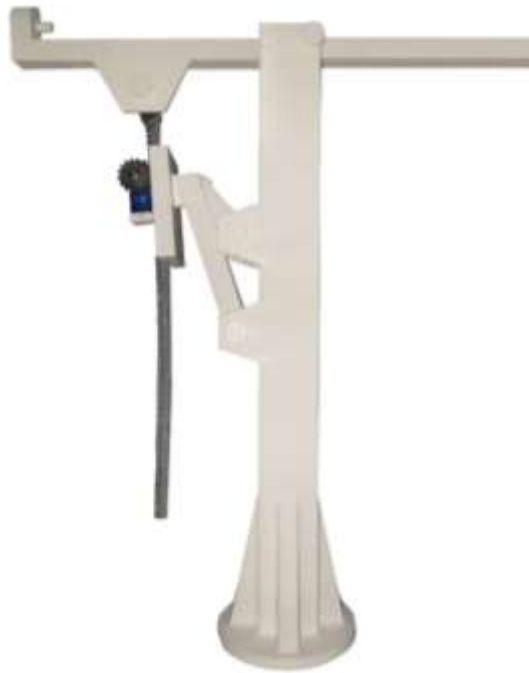
Figura 3.42 Montimi i motorrit dhe mbajtësit të tij
