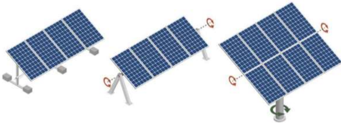
Figura 1.1 Llojet e instalimit të moduleve solare [1]
