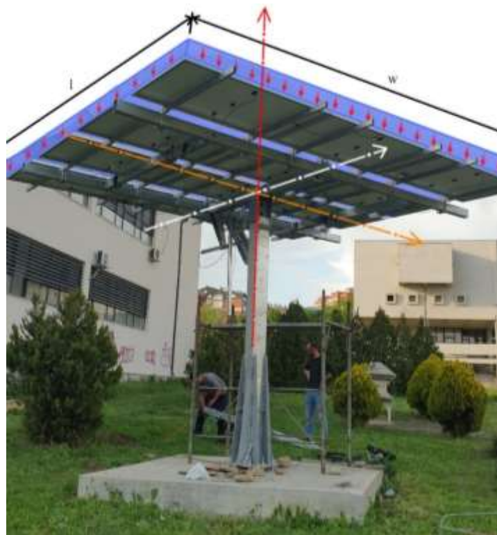
Figura 4.37 Mekanizmi final me borën e improvizuar
