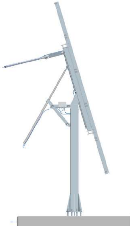
Figura 4.29 Pamja anësore e mekanizmit të përfunduar
