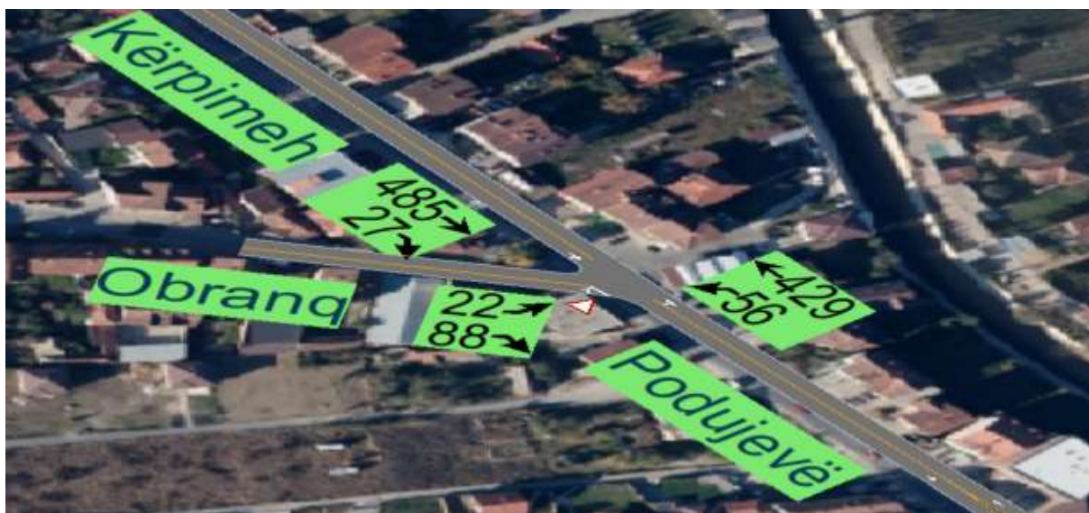
Figura 4.13: Paraqitja e udhëkryqit me anë të softuerit SIMTRAFFIC
