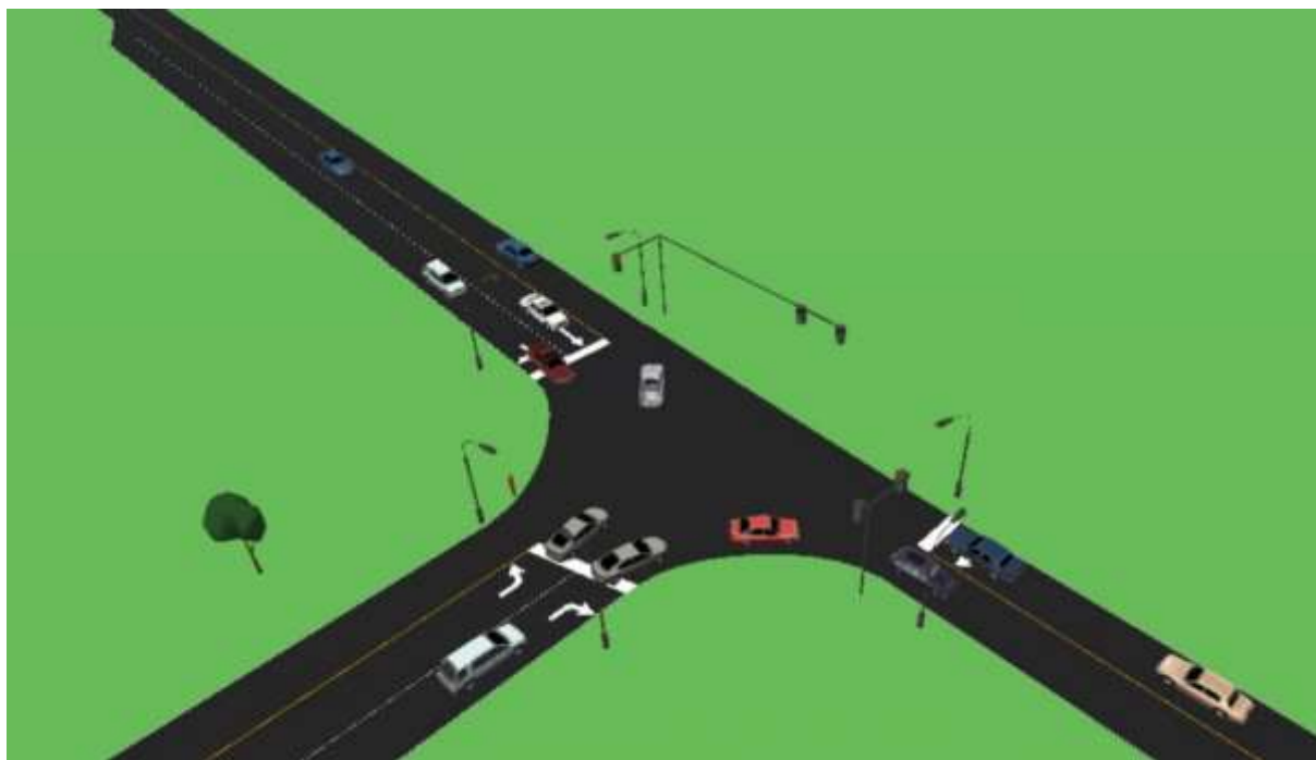
Figura 6.5: Pamja nga simulimi 3D i udhëkryqit të propozuar përmes softuerit SimTraffic
