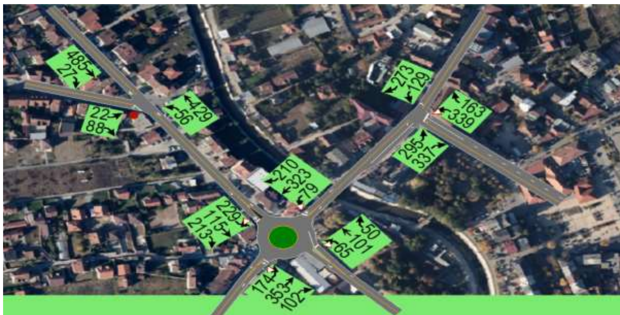
Figura 4.21: Gjendja ekzistuese e rrethrotullimit i paraqitur me SimTraffic
