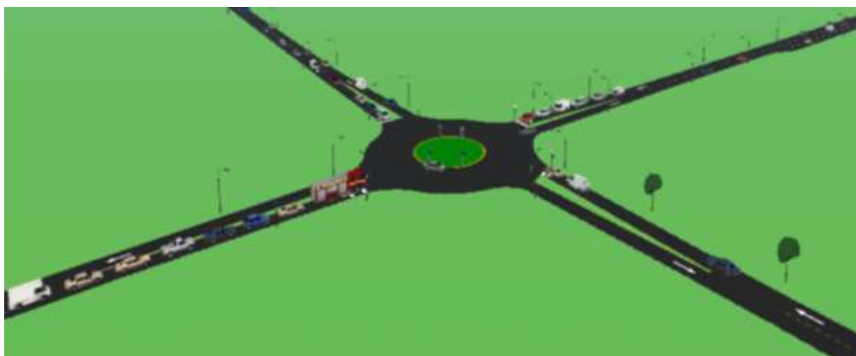
Figura 6.9: Pamja nga simulimi 3D i rrethrotullimit të propozuar përmes softuerit SimTraffic
