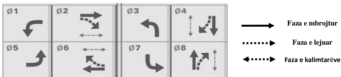
Figura 3.9: Diagram fazor me llojin e kthimit majtas - i mbrojtur
