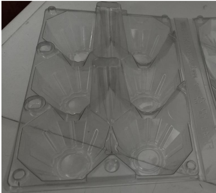
Figura 2.6: Kuti e prodhuar me metodën e termoformimit
