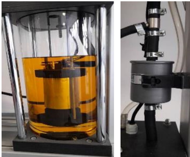
Figura 5.31: Pompa e karburantit dhe filtri
