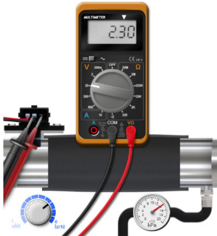
Figura 3.19: Gjenerimi i tensionit dhe rritja e presionit te rasti i motorit me turbo
