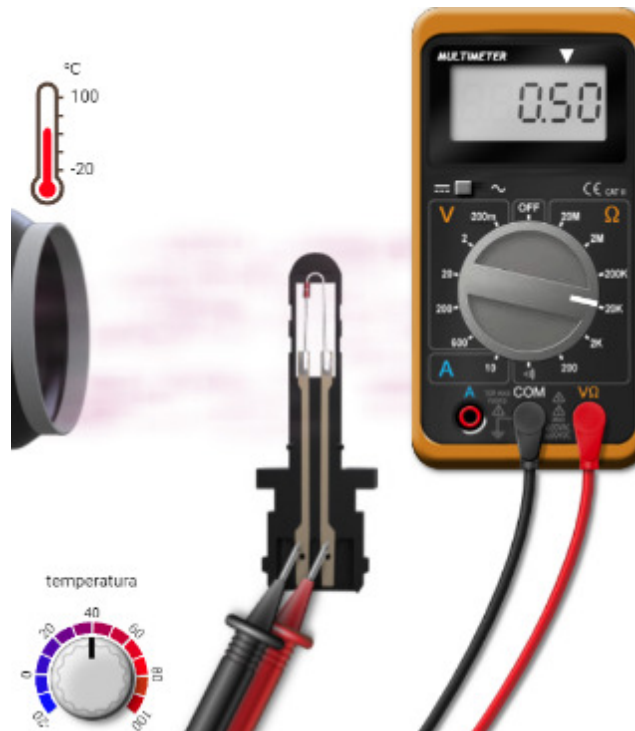
Figura 3.29: Funksionimi i sensorit të temperaturës së ajrit të freskët
