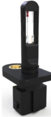
Figura 3.27: Senzori i temperaturës së ajrit që futet ne motor (ajrit të freskët)
