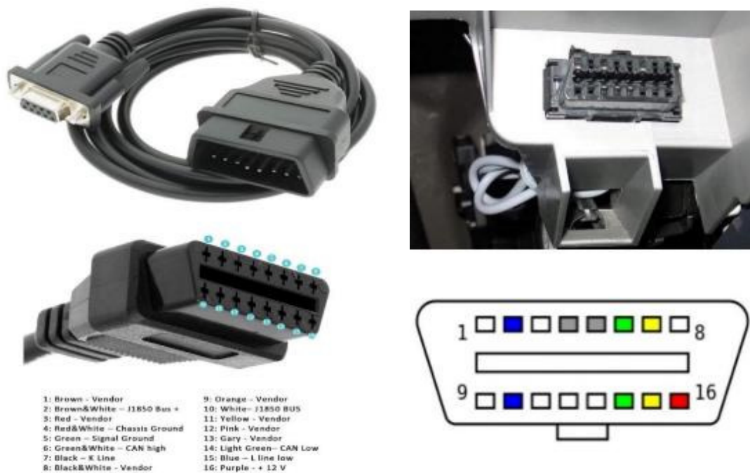
Figura 1.1: Kyçja e pajisjeve diagnostikuese në konektorin OBD II të automjetit
