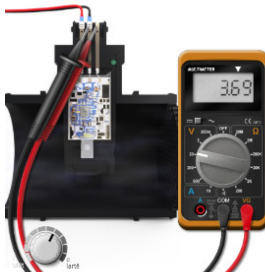
Figura 3.23: Ndryshimi i tensionit në matësin e prurjes - masës së ajrit që futet në motor
