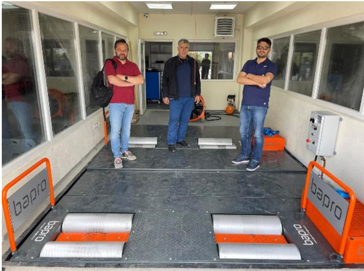
Figura 7.3: Pajisja testuese e fuqisë së motorit të automjeteve e modelit BPA-4R S
