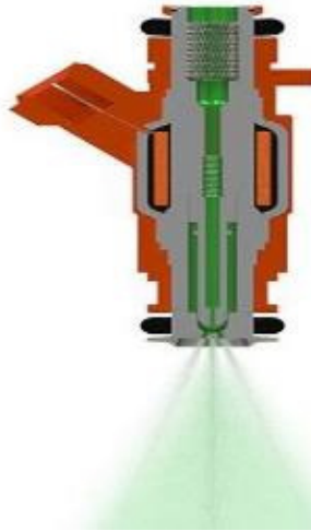
Figura 3.58: Parimi i funksionimit të injektorit
