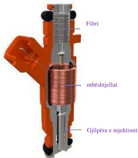
Figura 3.57: Pjesët përbërëse të injektorit që përdoret të sistemi i injektimit indirekt të motorët me benzinë
