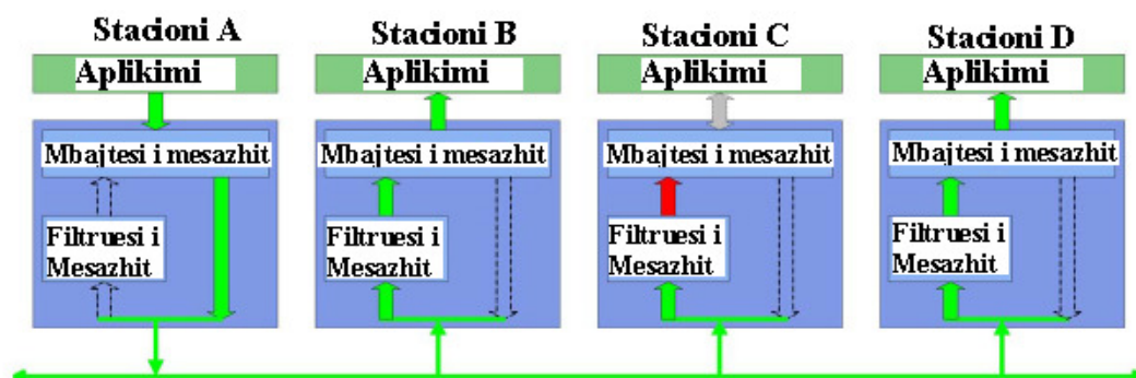
Figura 4.9: Paraqitje skematike e formës së dërgimit të mesazheve nëpërmjet CAN rrjetës
