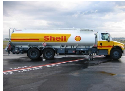
Fig.3.10. Autocisterna për lëndë djegëse [19]
