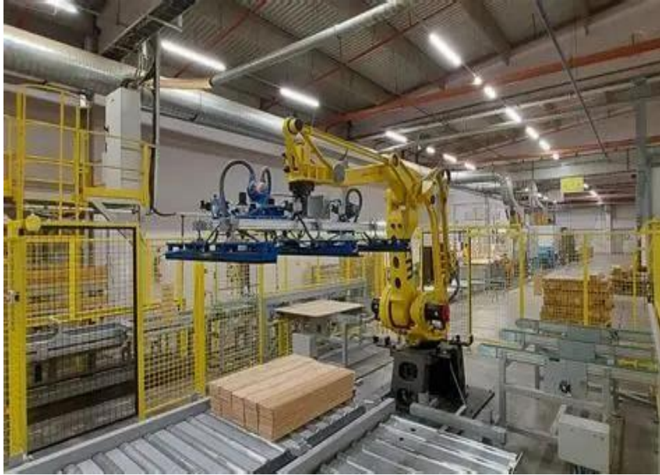
Fig.3.41.Zbatimi i robotit në automatizimin e depove [20]
