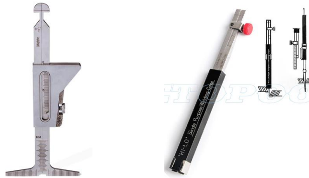
Figura 4. 9 Veglat për matjen e këndit të kanalit për saldim [6]
