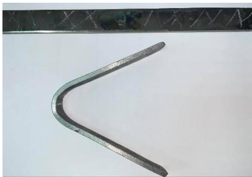
Figura 5. 21. Kampioni moster dhe kampioni i lakuar pas provës së përkuljes [5]
