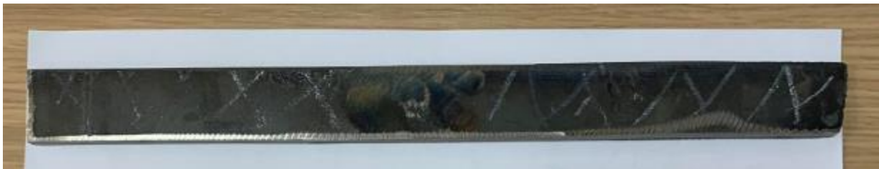
Figura 5. 17. Kampioni për realizimin e provës së përkuljes [5]
