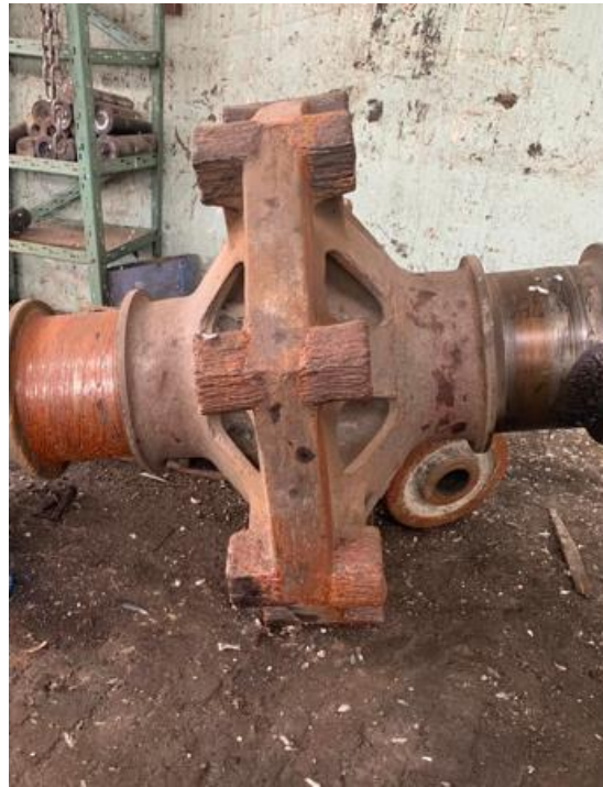
Figura 2. 1. Rigjenerimi i xhuntos [5]
