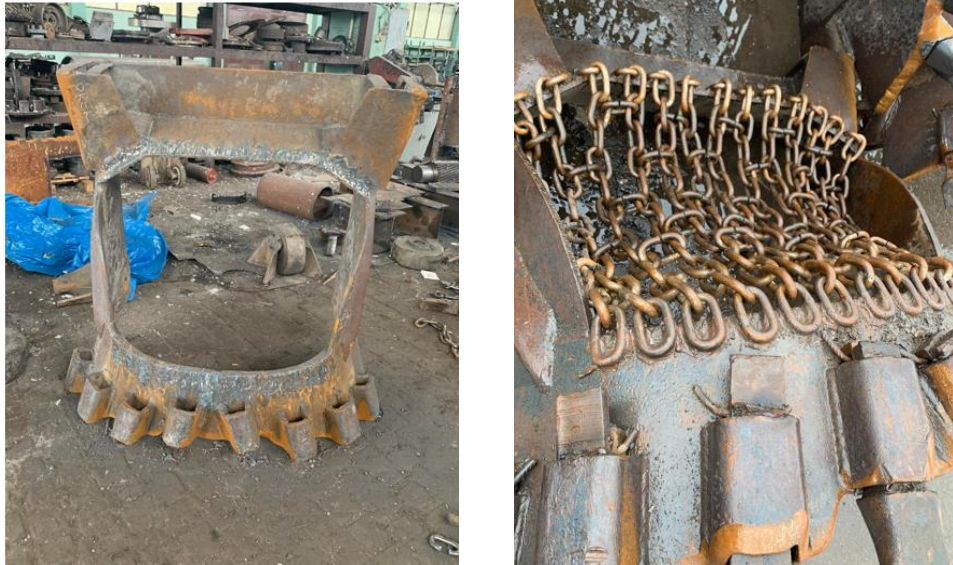
Figura 7. 18. Konstruksioni i lugës dhe zingjirët e salduar në lugë [5]
