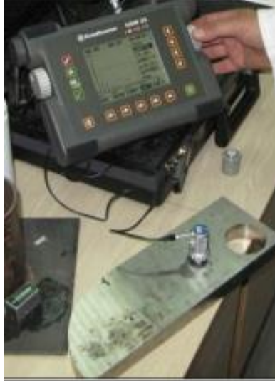
Figura 1. 2. Kontrolli me ultratingull [4]
