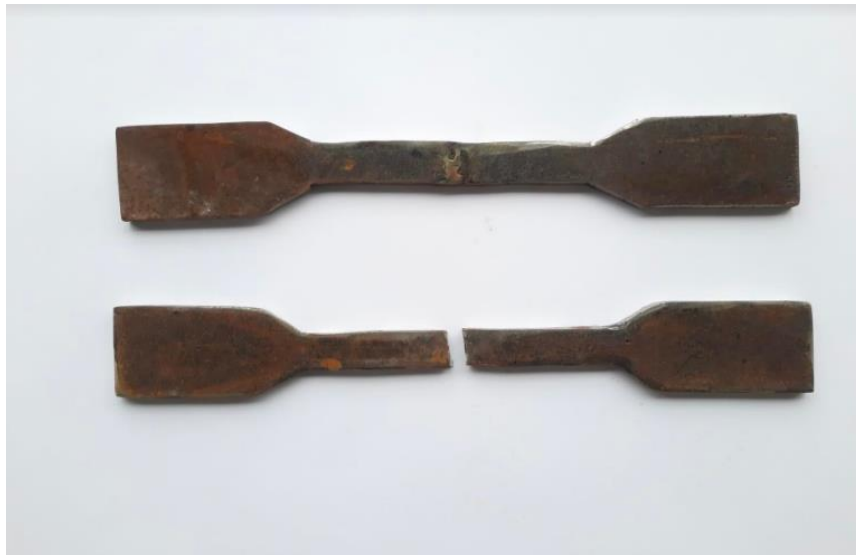
Figura 5. 13. Kampioni moster dhe kampioni i këputur pas provës së tërheqjes [5]
