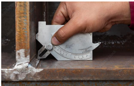
Figura 4. 10 Vegla për matjen e këndit tek saldimi këndor [7]
