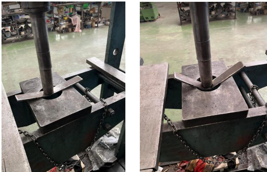
Figura 5. 18. Vendosja e kampionit në makinën e përkuljes dhe përkulja e tij [5]
