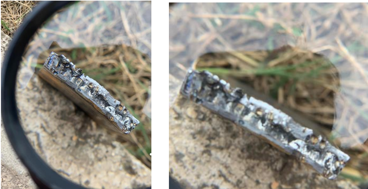
Figura 5. 24. Kontrolli vizuel i përcaktimit të gabimeve të procesit të saldimit [5]
