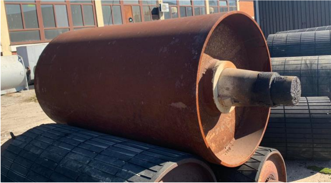
Figura 4. 4 Tamburi i korroduar [5]
