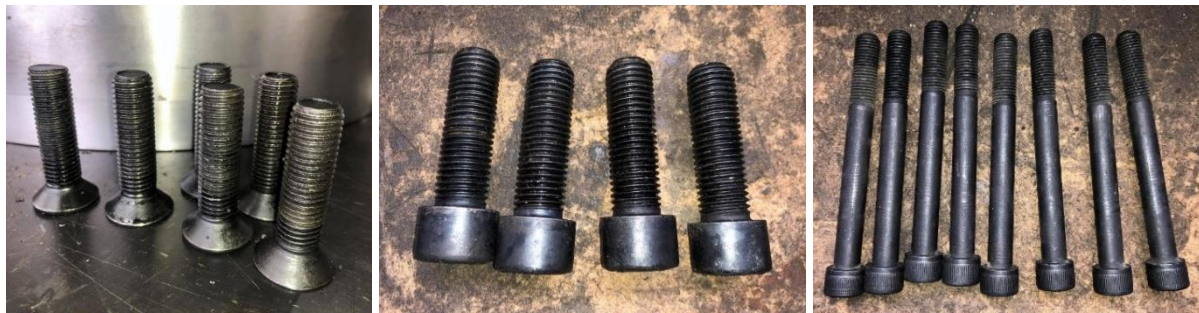
Figura 65. Bulonat: a) ISO 10642 – M20×80; b) ISO 10642 – M16×50; c) ISO 10642 – M16×160
