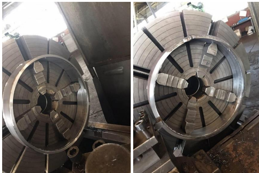
Figura 59. Pozicionimi dhe shtërngimi i copës punuese dhe IMP për përpunim
