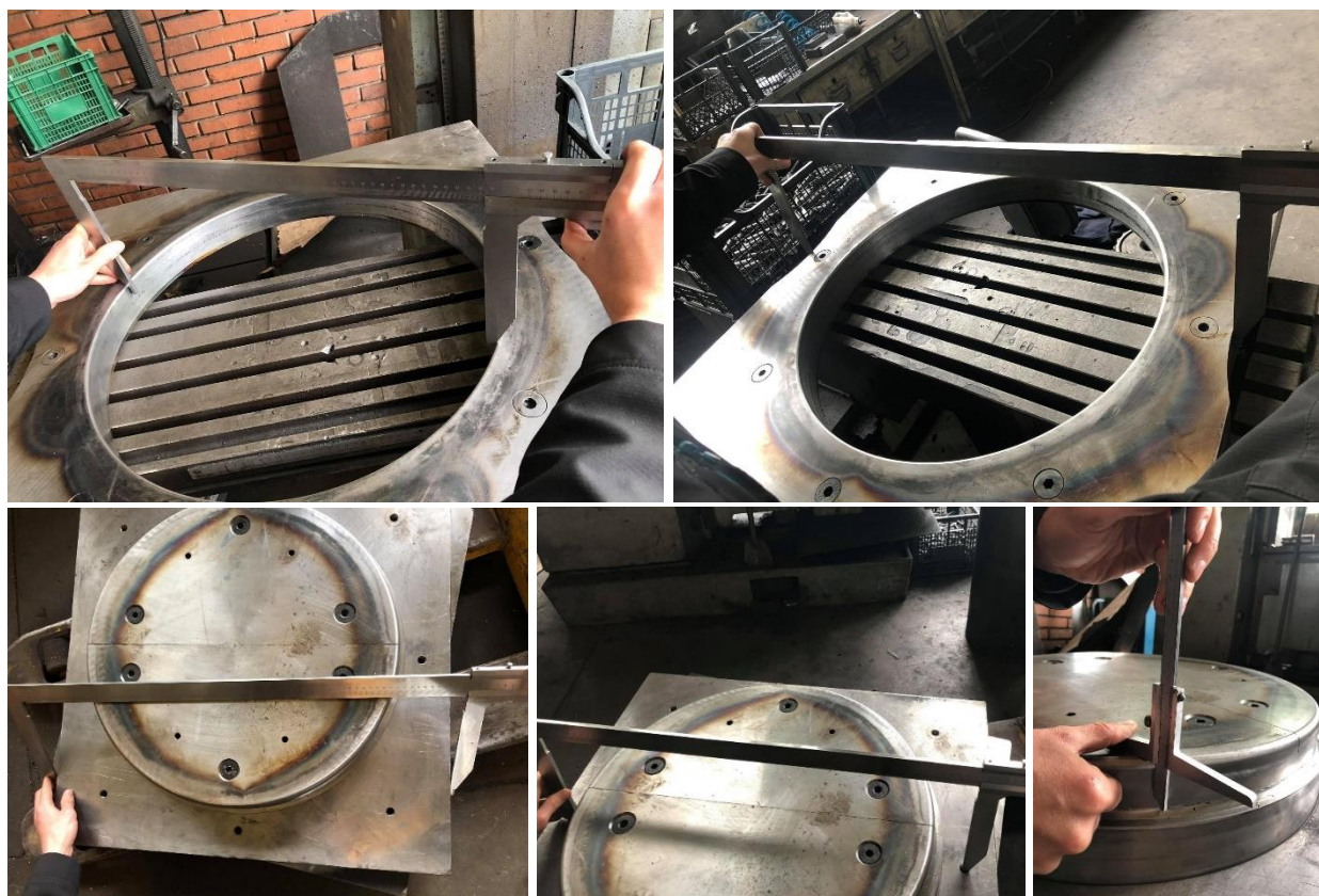
Figura 66. Kontrolla e detaleve me instrumente të ndryshme matëse
