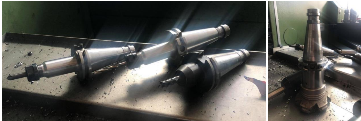
Figura 50. Instrumente frezuese: a) për centrim, shpim dhe frezim; b) për frezim ballor
