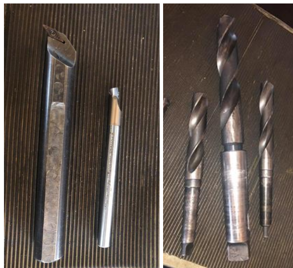
Figura 45. Instrumente për tornim: a) thika për tornim të brendshëm; b) punto spirale
