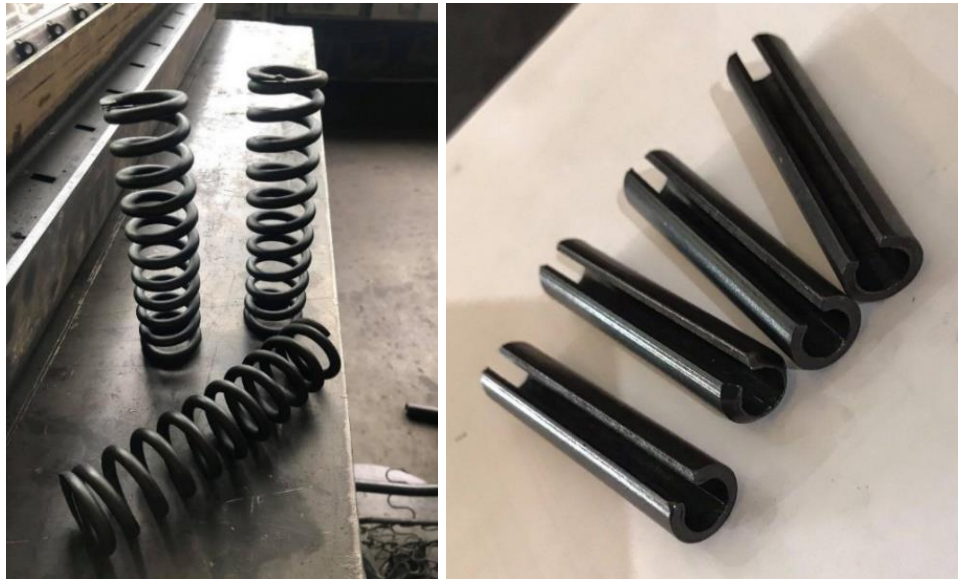
Figura 64. Pjesët e veglës: a) sustat; b) shtifnet
