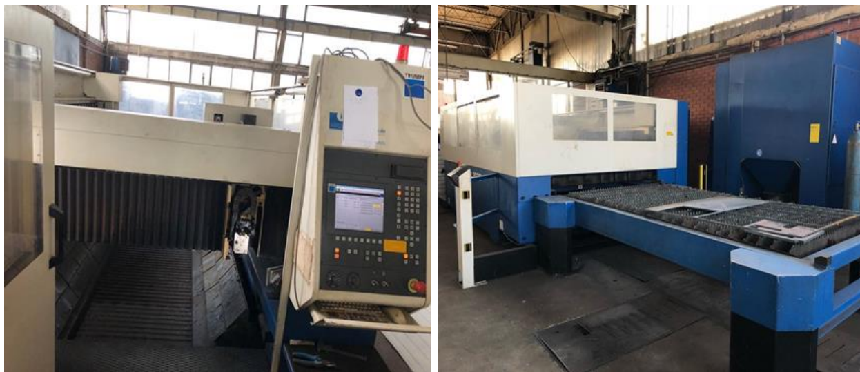
Figura 43. Laseri me dy tavolina pune: a) pjesa ballore dhe b) pjesa mbrapa makinës
