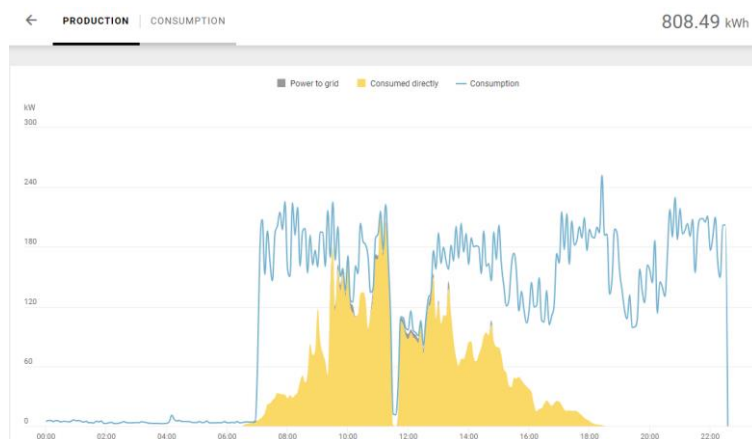
Fig. 35 Prodhimi ditor i energjisë elektrike nga sistemi solarë në një ditë me shi ([18])
