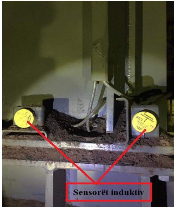
Fig. 5.2 Sensorët induktiv në hinkën mbi thërrmues
