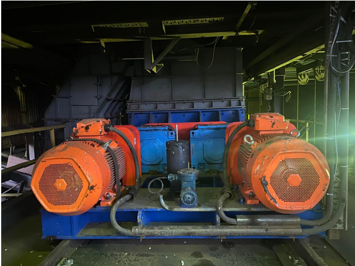
Fig.3.1 Thërrmuesi me ingranim në fabrikë
