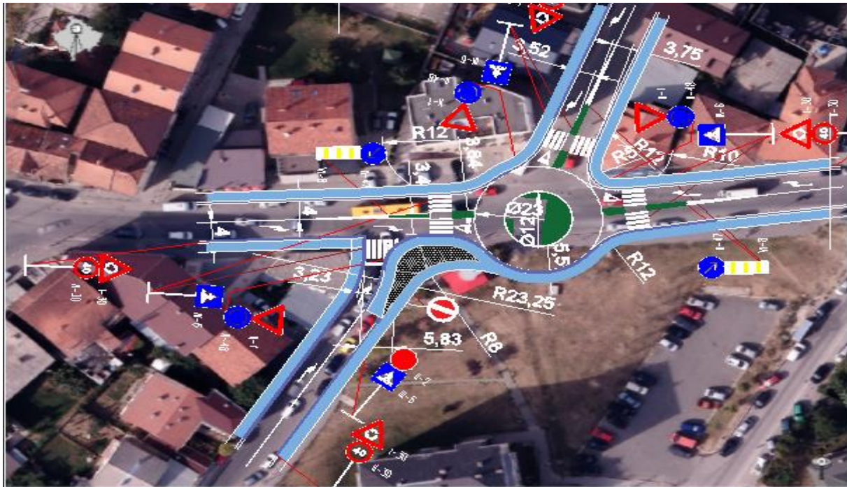
Figura 8.9: Komplet udhëkryqi rrethor i propozuar
