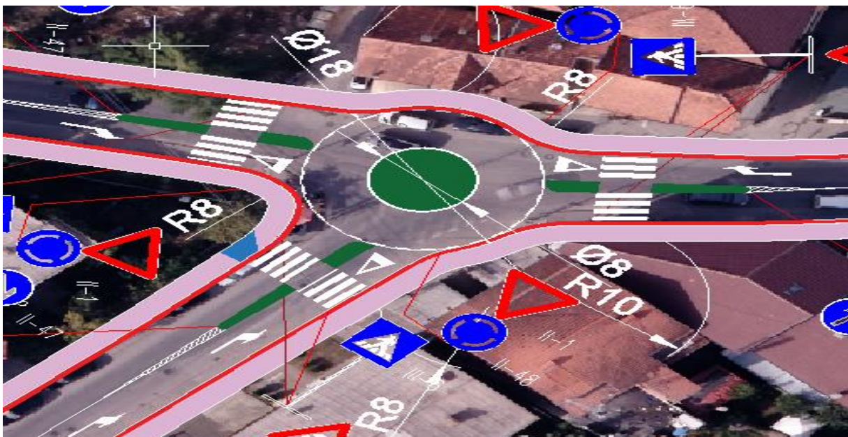
Figura 8.5: Diametri i rrethit si dhe rrezet hyrëse dhe dalëse
