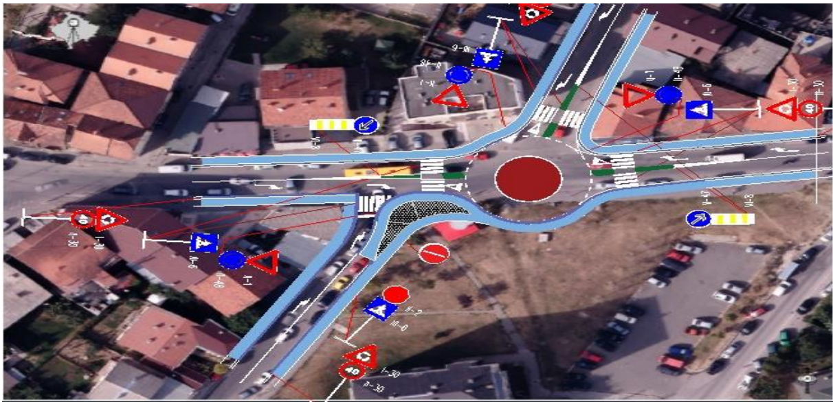
Figura 8.7: Mini - rrethrotullimi i propozuar si zgjidhje
